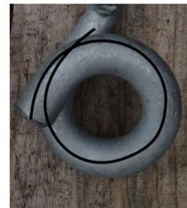
Dans une section horizontale, la corde doit bien reposer sur la première courbe vers le bas par rapport à l'endroit de fixation de façon à ce que la corde reste bien dans la queue de cochon (photo de gauche). Sur la photo de droite, la corde ne devrait pas sortir trop facilement, mais la traction s'exerce dans un sens qui va vers l'ouverture de la queue de cochon.
