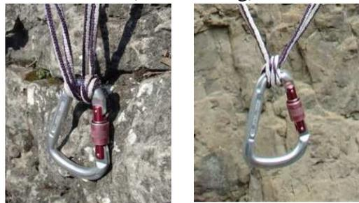
**Photo C** : avec deux sangles séparées, si ces deux sangles sont fixées chacune par un nœud de tête d'alouette au lieu d'être placée dans un mousqueton de sécurité, leur R est réduite à env 1200 kg, mais comme il y a 2 sangles, la R globale est encore de **2400 kg**. La R reste de 2 x 2200 kg si les sangles sont fixées au moyen de mousquetons de sécurité.
