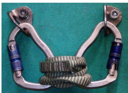
Bien veiller à ne pas trop raccourcir la sangle, les 2 mousquetons doivent rester « verticaux » et ne pas être forcés à une position oblique comme sur la photo ci-contre.
